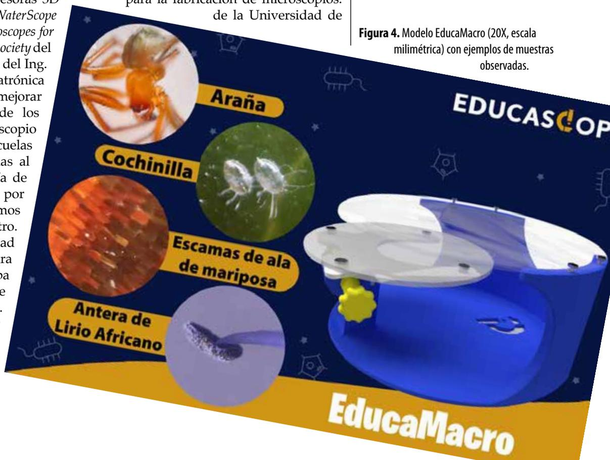
**Figura 4.** Modelo EducaMacro (20X, escala milimétrica) con ejemplos de muestras observadas.
